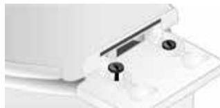
C) Coloque el asiento en el inodoro e inserte los tornillos en sus barrenos, ajuste la tapa para que quede centrada en el inodoro.
