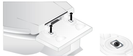
B) Introduzca el tornillo dentro de la arandela metálica y en el barreno de la cerámica.
