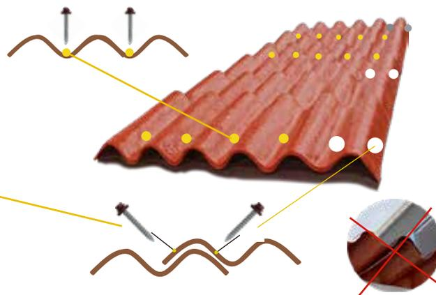
Materiales Atornillador inalámbrico, sierra circular, serucho, punta hexagonal 3/8, punta de cruz, pijas punta de broca, sellos para pija, gancho para colocar lámina.
