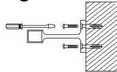
4.- Introduzca en el barreno el taquete de forma tal que llegue hasta el fondo. Retire con una navaja el sobrante del taquete (al raz del muro), Coloque el accesorio y sujetelo con la pija. Verifique que el accesorio este centrado y a la distancia deseada, de ser así, repita los pasos 2,3 y 4 con el siguiente barreno..
